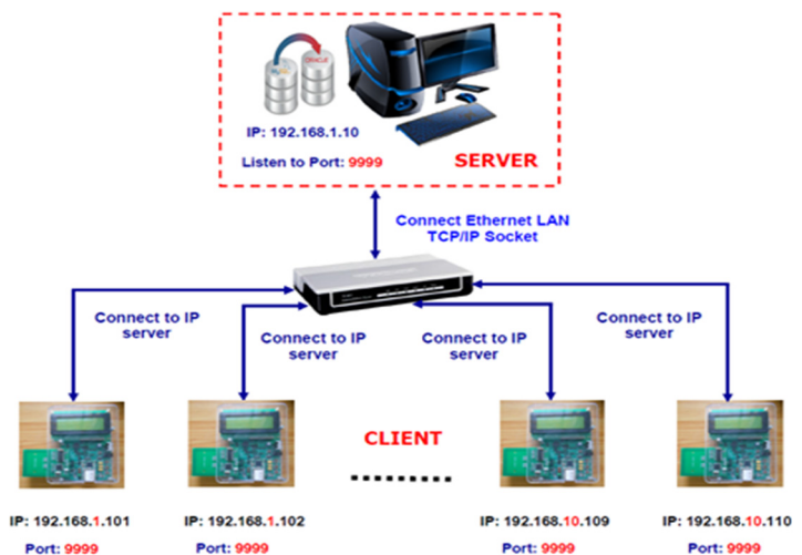
Hình 12: Sơ đồ kết nối server + LAN + các client
